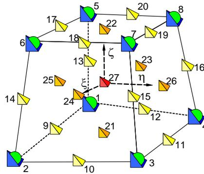
Fig. 1. Finite element HC8/27
